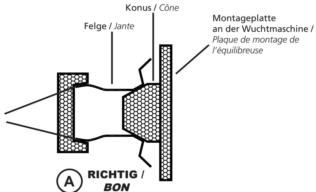
**Bild B:** Hier dargestellt, wie üblicherweise Räder ausgewuchtet werden.
